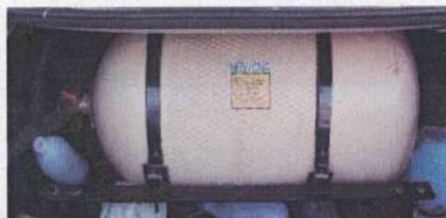
รูปถัง CNG-1
