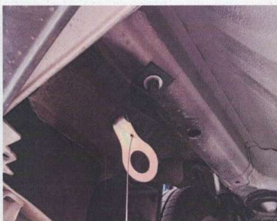
รูปการติดตั้งท่อนำก๊าซสำหรับบรรจุก๊าซกรณีติดตั้งถังภายในตัวถังรถ (ถ้ามี)
