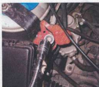
รูปการตรวจสอบการรั่วของระบบก๊าซ
