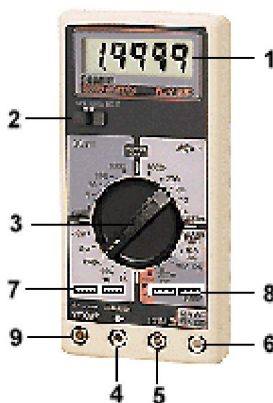
รูปที่ 1.5 มัลติมิเตอร์แบบตัวเลข (Digital multimeter)
