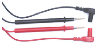
รูปที่ 1.8 ขั้วบวกสายวัดสีแดง ขั้วลบสายวัดสีดำ
