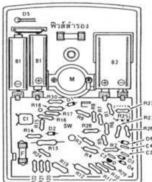
รูปที่ 1.9 ตำแหน่งแบตเตอรี่ และพิวส์ ในมัลติมิเตอร์แบบเข็ม ที่มา : http://www.tatc.ac.th/elearning_elec/Untitled-3.html
