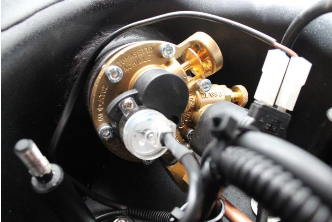
รูปการติดตั้งล้นควบคุมการเปิดปิดก๊าซ
