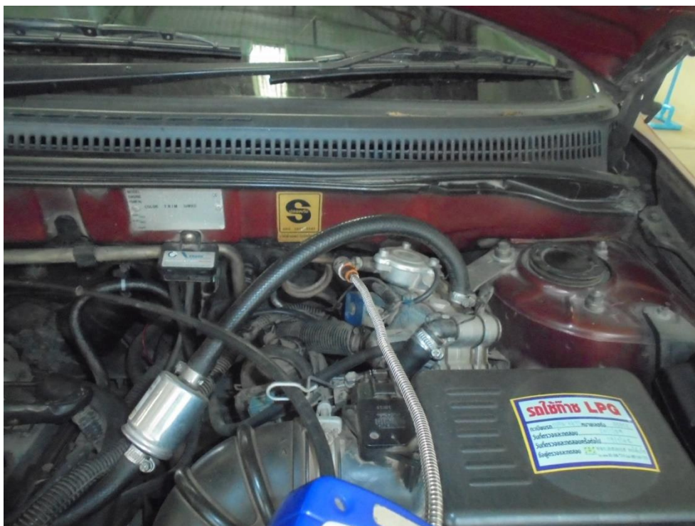
รูปการตรวจสอบการรั่วไหลของก๊าซ
